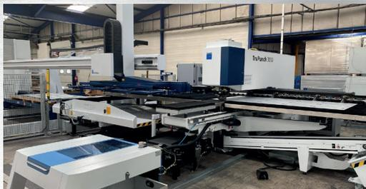
*2 poinçonneuses (dont une avec chargement et déchargement automatique)*
