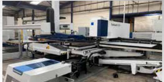
**2 poinçonneuses (dont une avec chargement et déchargement automatique)**
